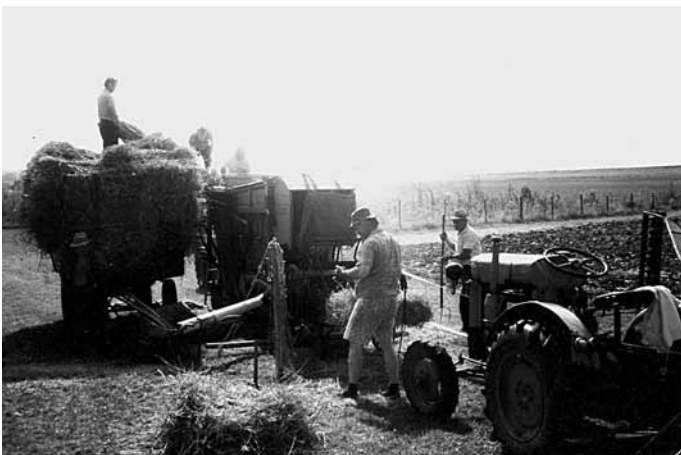
Eine alte Dreschmaschine. Damals und auch heute (siehe Foto) wurde sie zum Dreschen von Getreide genutzt, konnte sowohl mit einer Dampfmaschine als auch mit einem Elektromotor (auch Traktor) angetrieben werden.
